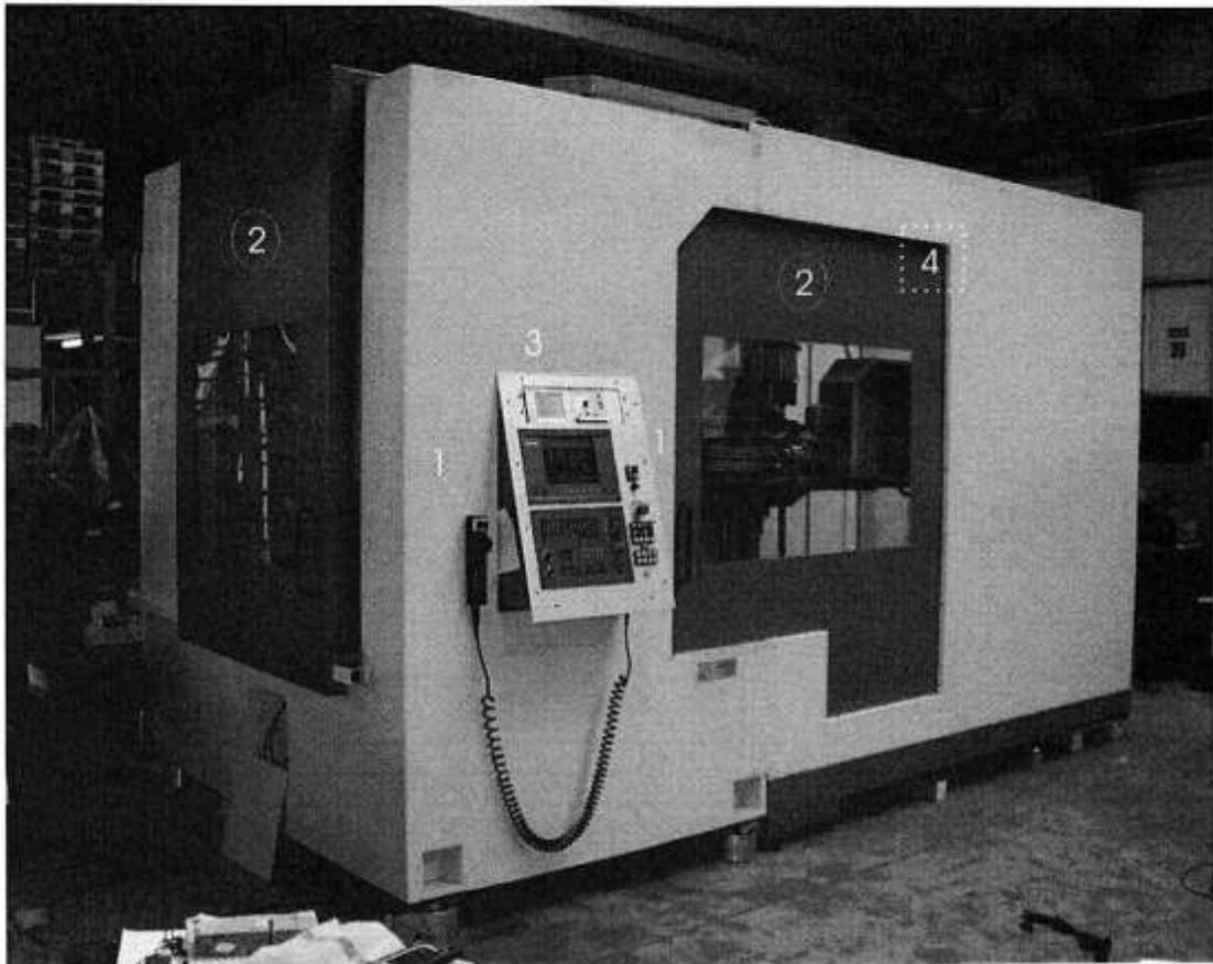
Abbildung 3-2 Aktive Schutzvorrichtungen
